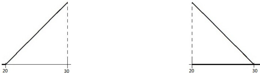
Figure 4: Grafico della funzione di densità di probabilità di due variabili casuali triangolari X_1 e X_2 , entrambe distribuite fra 20 e 30. X_1 ha il massimo in x_1 = 30 . X_2 ha il massimo in x_2 = 20 . Per entrambe il massimo vale 1/5 .
